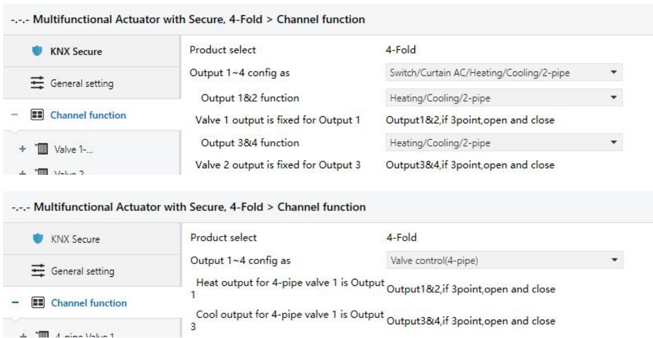
Fig. 4.9(1) Parameter window Channel function--valve type”
