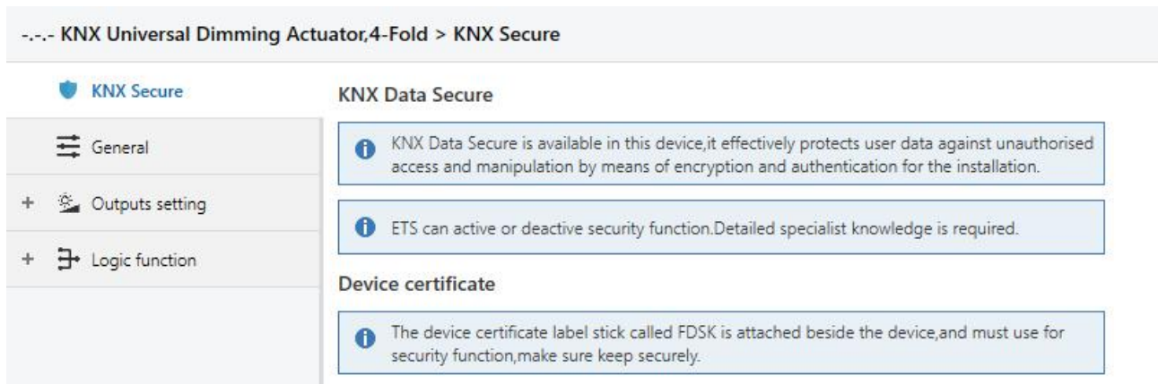
Fig.5.1 (1) "KNX Secure" parameter window
