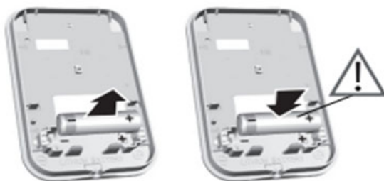
Lithium battery - AA LS 14500 3,6 V
