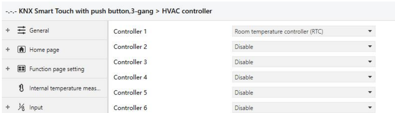
Fig.5.4 “HVAC controller” parameter window
