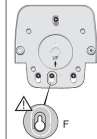
FR F = Autoprotection à l'arrachement. Attention à ne pas détériorer cette partie du support (nécessaire à l'autoprotection). Vissez avec précaution.
