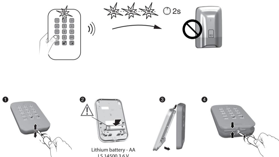
**FR** Le voyant clignote rouge à chaque appui, la pile est usée (< 2,7V). Avant d'ouvrir le boîtier, la centrale doit être en mode Maintenance (voir notice d'installation système).
